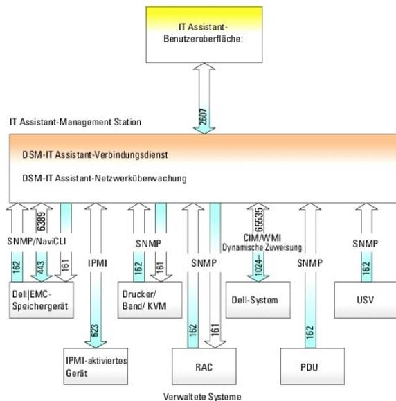
**ANMERKUNG:** Die Zahlen in [Abbildung 1-1](#) sind die von IT Assistant zur Kommunikation mit den verwalteten Systemen verwendeten Anschlussnummern. Weitere Informationen zu den von IT Assistant verwendeten Anschlüssen finden Sie unter "[UDP/TCP-Standardanschlüsse von IT Assistant](#)".
